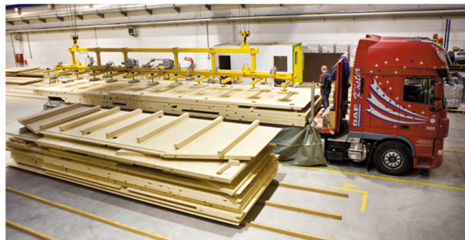
eine durchdachte Stapelreihenfolge ermöglicht die schnelle Montage
