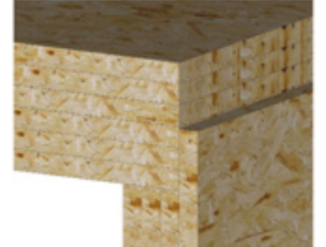
Decke auf Außenwand
